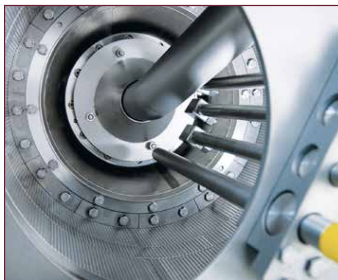
Figura 5 – Interno di una centrifuga tipo "pusher" utilizzata a valle del concentratore.
